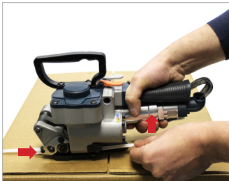
Inserimento della reggetta Insert strap
