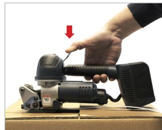
Saldatura tramite leva
