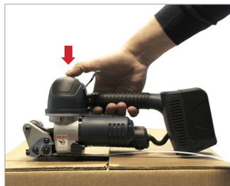
Tensionamento tramite pulsante
