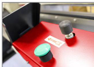
AVVIO CICLO LAVORO DA PULSANTE WORKING CYCLE ACTIVATED BY BUTTON
