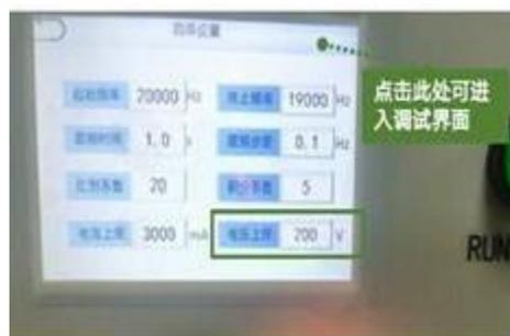
**Eccezione2:** Allarme sovraccarico tensione.
