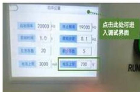
**Eccezione2:** Allarme sovraccarico tensione. Risoluzione del problema: impostare il limite del voltaggio a 1000V
