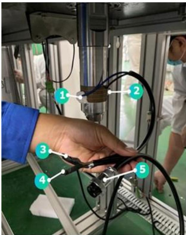
Risoluzioni positive e negative della testa di saldatura ad ultrasuoni
