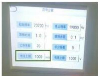
**Eccezione1:** Allarme sovraccarico corrente. Risoluzione del problema: impostare il limite corrente a 3000 mA
