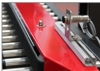
FOTOCELLULA LETTURA SCATOLA FOTOCELLS THAT DETECT BOX
