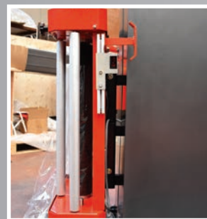
Carrello con tensionamento meccanico Mechanical brake carriage
