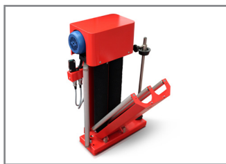
CARRELLO CON PRESTIRO MOTORIZZATO PRE-STRETCH FILM CARRIAGE
