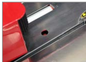
SENSORE PER REGGIATURA AUTOMATICA AUTOMATIC STRAPPING SENSOR
