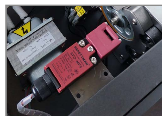
INTERRUTTORE DI SICUREZZA SAFETY SWITCH
