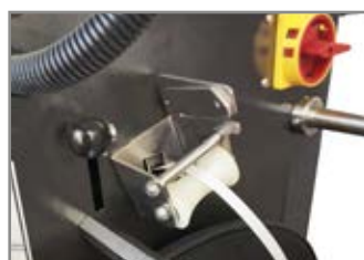
CARICAMENTO AUTOMATICO DELLA REGGIA AUTOMATIC STRAP LOADING
