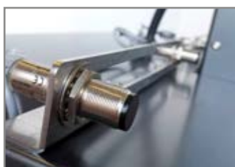
FOTOCELLULA LETTURA PRODOTTO PHOTOCELL TO DETECT PRODUCTS
