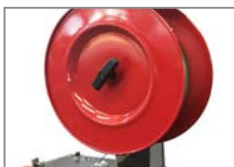
INNESTO/DISINNESTO RAPIDO BOBINA FAST STRAP COIL CHANGE
