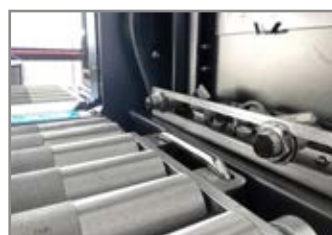
FOTOCELLULE PER LETTURA PACCO PHOTOCELLS TO DETECT THE PRODUCTS
