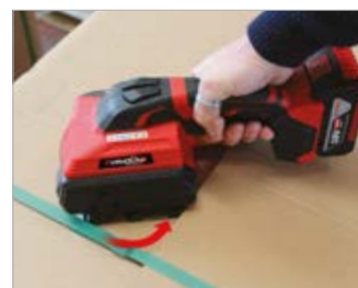
Sgancio automatico della reggetta Automatic strap release
