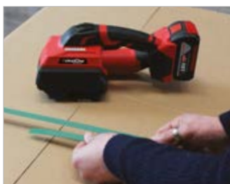
Inserimento reggetta Strap insertion
