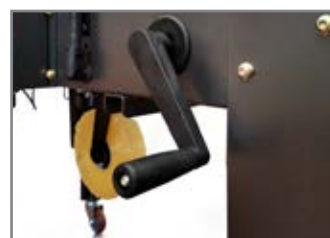
REGOLAZIONE LARGHEZZA SCATOLA BOX WIDTH ADJUSTMENT
