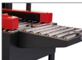
RULLIERA INGRESSO/USCITA DI SERIE INFEED/OUTFEED ROLLERS INCLUDED
