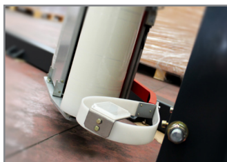
BUMPER DI ARRESTO MACCHINA SAFETY BUMPER
